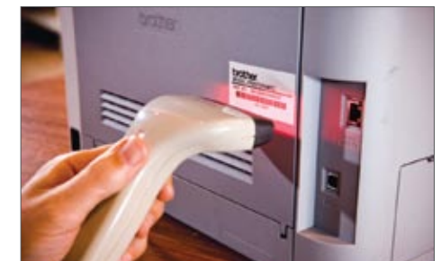
Conecte un escáner de códigos de barras al puerto serie de la impresora para imprimir etiquetas directamente desde las TD-4000/TD-4100N*
